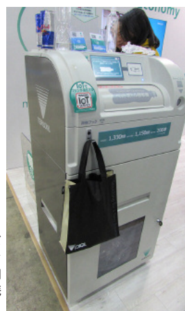
減容回収機「ボトルスカッシュ」。入口が横向きで奥行きが浅くコンパクト
